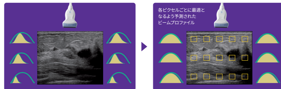
従来 画像全体で均一ではなく、深部のハーモニック成分は減弱
