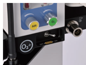
オープン回路用のACGOスイッチ ACGO使用中は安全の為、画面に "ACGO"表示
